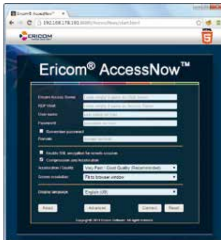
Bild 2. Über diese Eingabemaske können Benutzer auf ihrem Client angeben, wie sie die Verbindung zum Accessnow-Server herstellen wollen.
